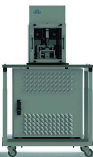
Прибор срезной криологический ГТ 1.2.14
