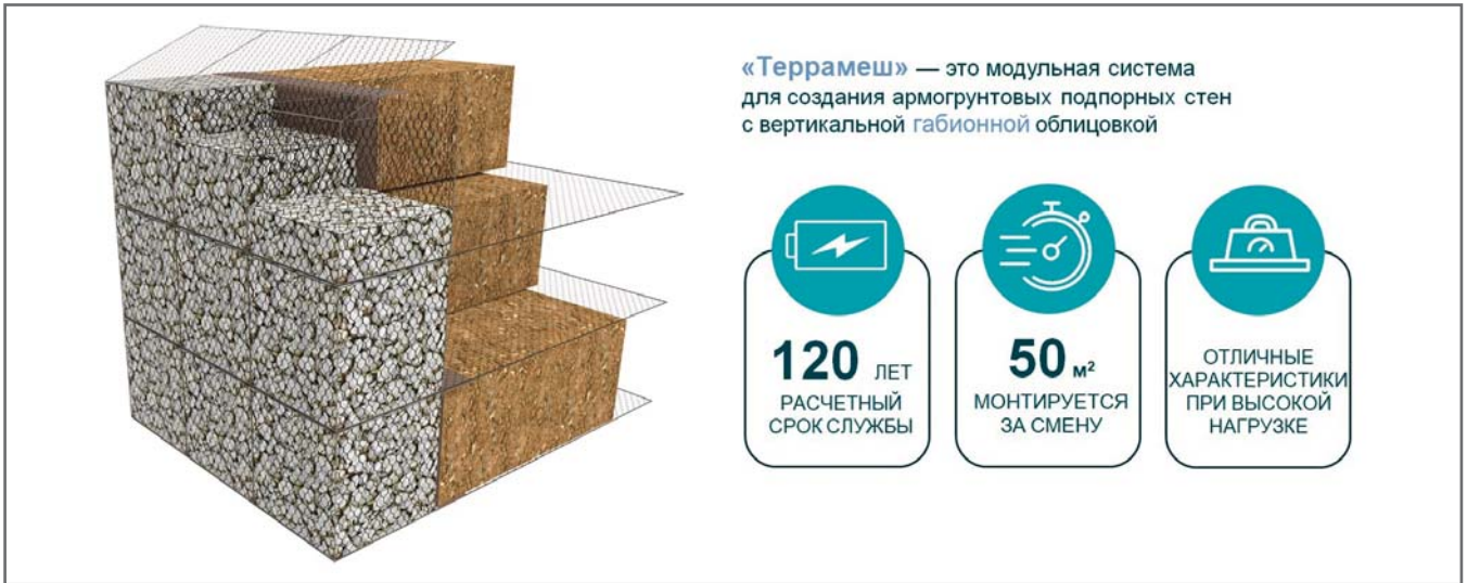
Рис. 1. Схематичное изображение устройства армированного сооружения на основе системы «Террамеш» и преимущества этой системы
