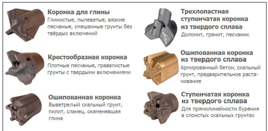
Рис. 6. Основные типы буровых коронок [8]
