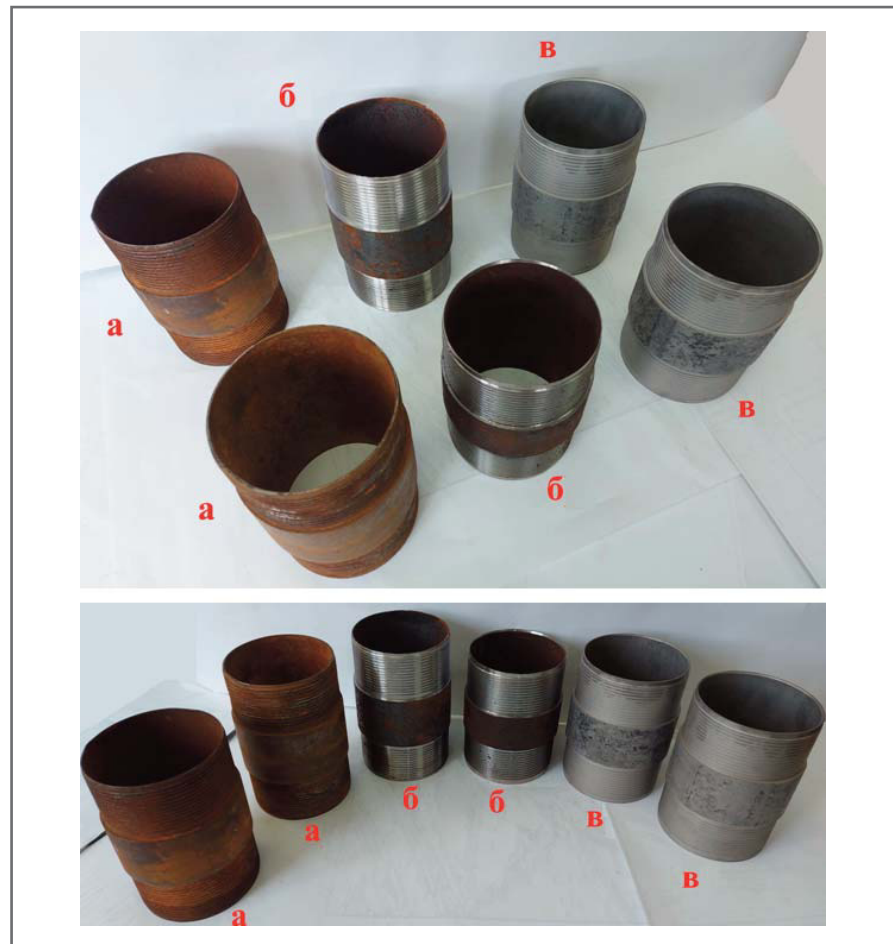
Рис. 1. Опытные образцы ниппелей для соединения обсадных труб, прошедшие газовую вакуумную карбонитрацию, в сопоставлении с необработанными образцами: а – типовые заводские образцы (видно, что эти металлические изделия с резьбой покрыты ржавчиной); б – типовые ниппели со «свеженарезанной» резьбой; в – карбонитрированные ниппели
