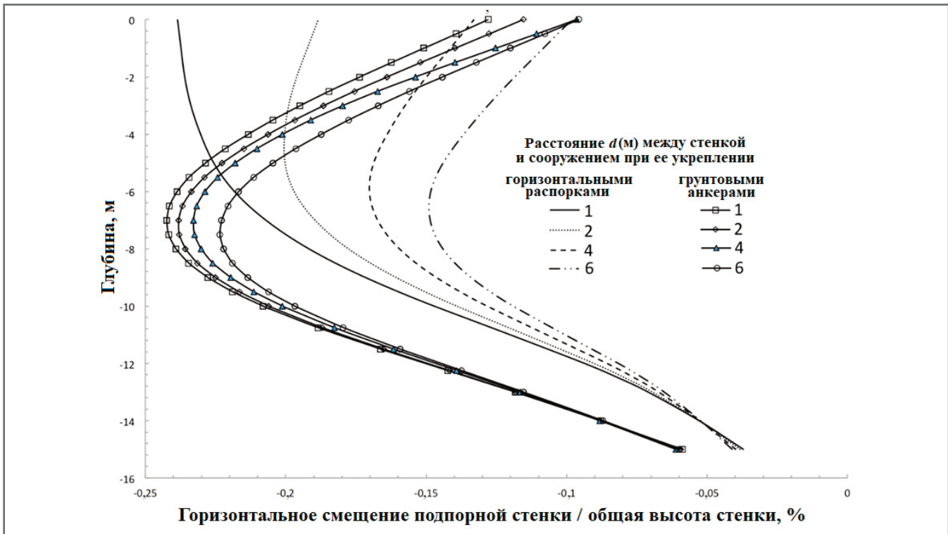
Рис. 8. Изменения горизонтальных смещений подпорной стенки с глубиной при разных расстояниях ( d ) между ней и соседним наземным сооружением
