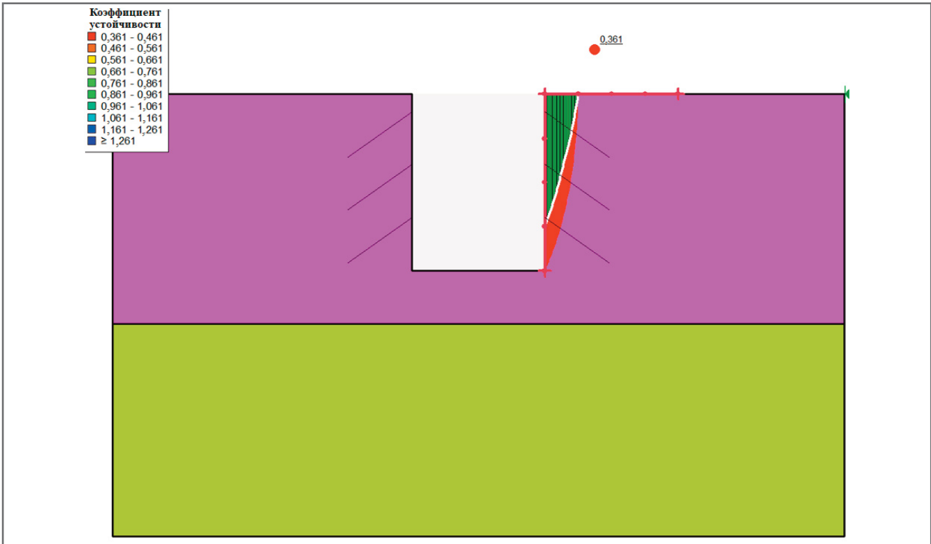
Рис. 5. Критическая круглоцилиндрическая поверхность скольжения
