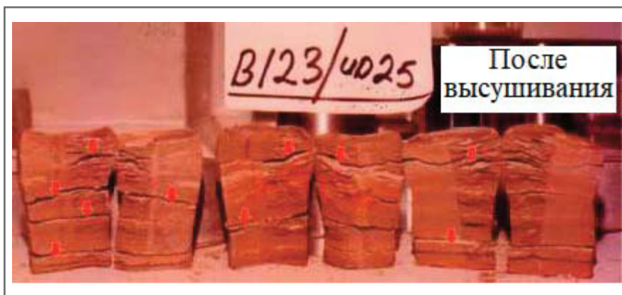
Рис. 5. Глинистые участки испытанных и разрезанных образцов после высушивания могут сжиматься, что позволяет выявить неоднородности
