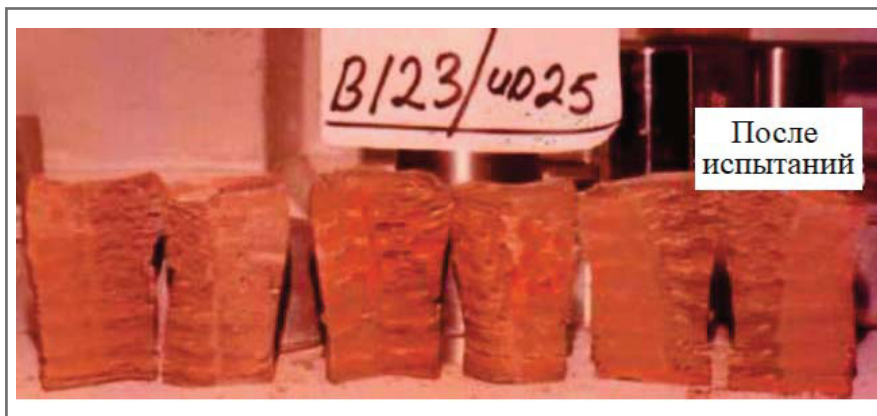
Рис. 4. Ненарушенные образцы, разрезанные после испытаний
