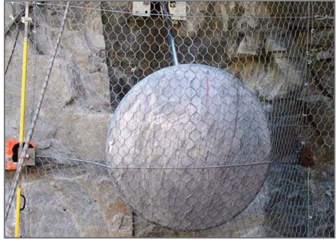
Рис. 5. Испытание конструкции «Стилгрид®» на продавливание
