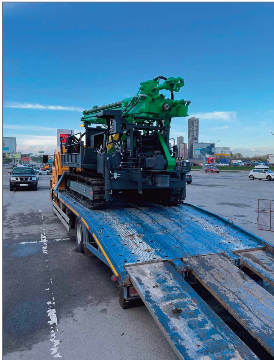
Рис. 2. Перевозка ПБУ-2 на гусеничной тележке на дальние расстояния с помощью быстроходной грузовой техники
