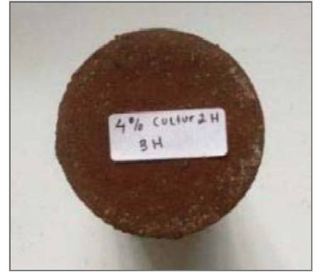
Рис. 4. Поверхность образца с бактериями через несколько дней выглядит слегка беловатой
