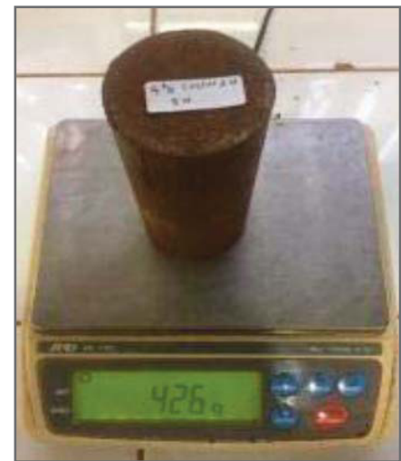
Рис. 5. Образец грунта перед испытанием на одноосное сжатие
