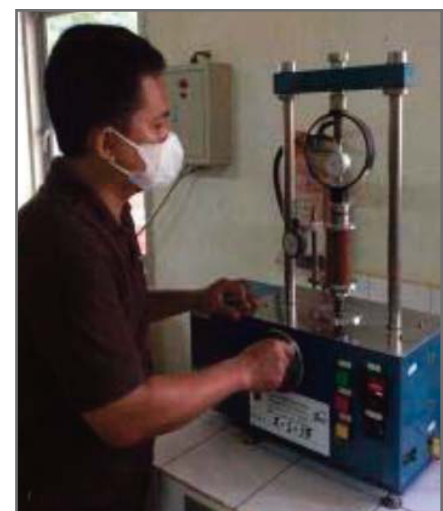
Рис. 6. Испытание образца грунта на одноосное сжатие
