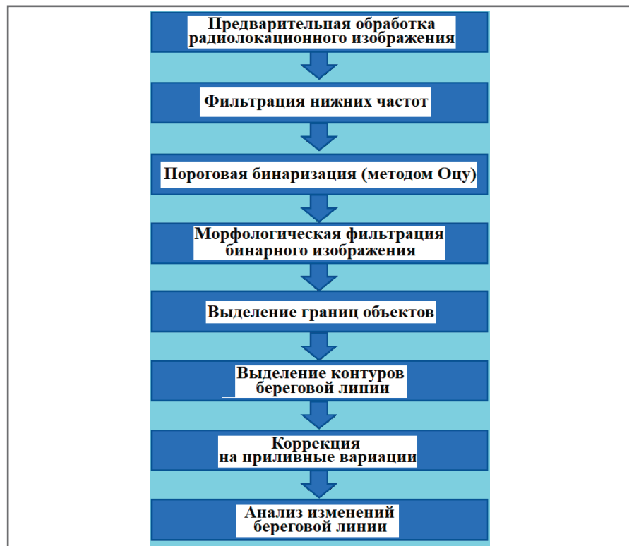
Рис. 3. Этапы обработки радиолокационных снимков для выделения береговой линии и расчетов ее изменений
