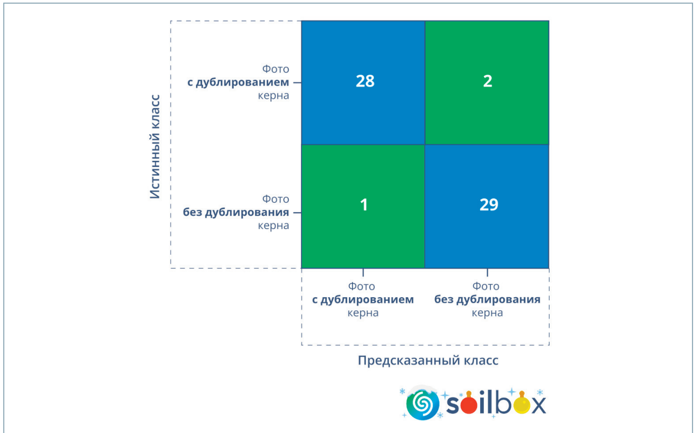
Рис. 6. Матрица ошибок (confusion matrix) бинарной классификации изображений керна. Классы включают «фото с дублированием керна» и «фото без дублирования керна». По диагонали зеленым цветом показано количество корректных классификаций. По диагонали синим цветом показано количество ошибок классификации
