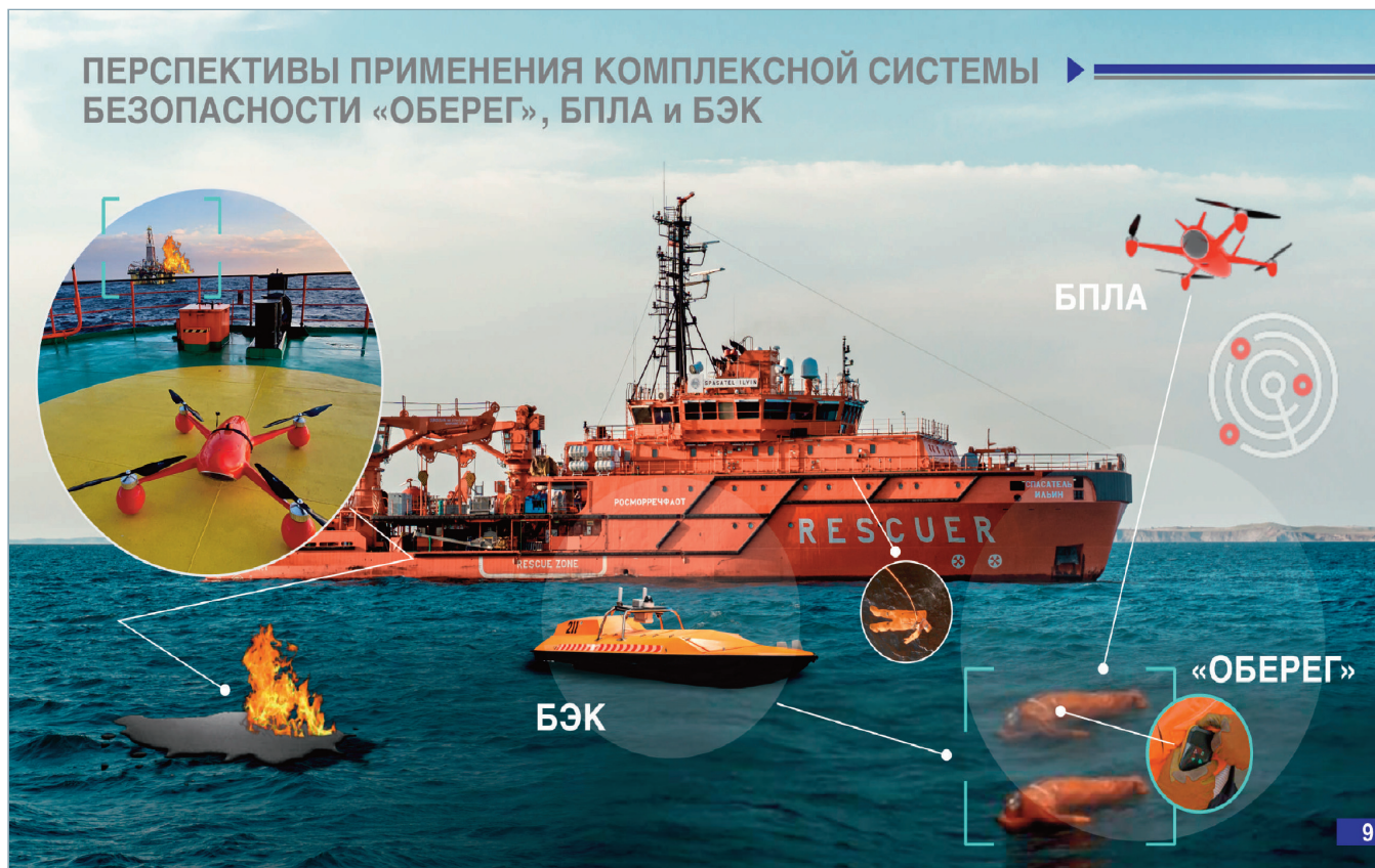
Рис. 8. Перспективы применения комплексной системы мониторинга безопасности морских и прибрежных объектов «Оберег», беспилотных летательных аппаратов (БПЛА) и безэкипажных катеров (БЭК) (из презентации А. Науменко)
