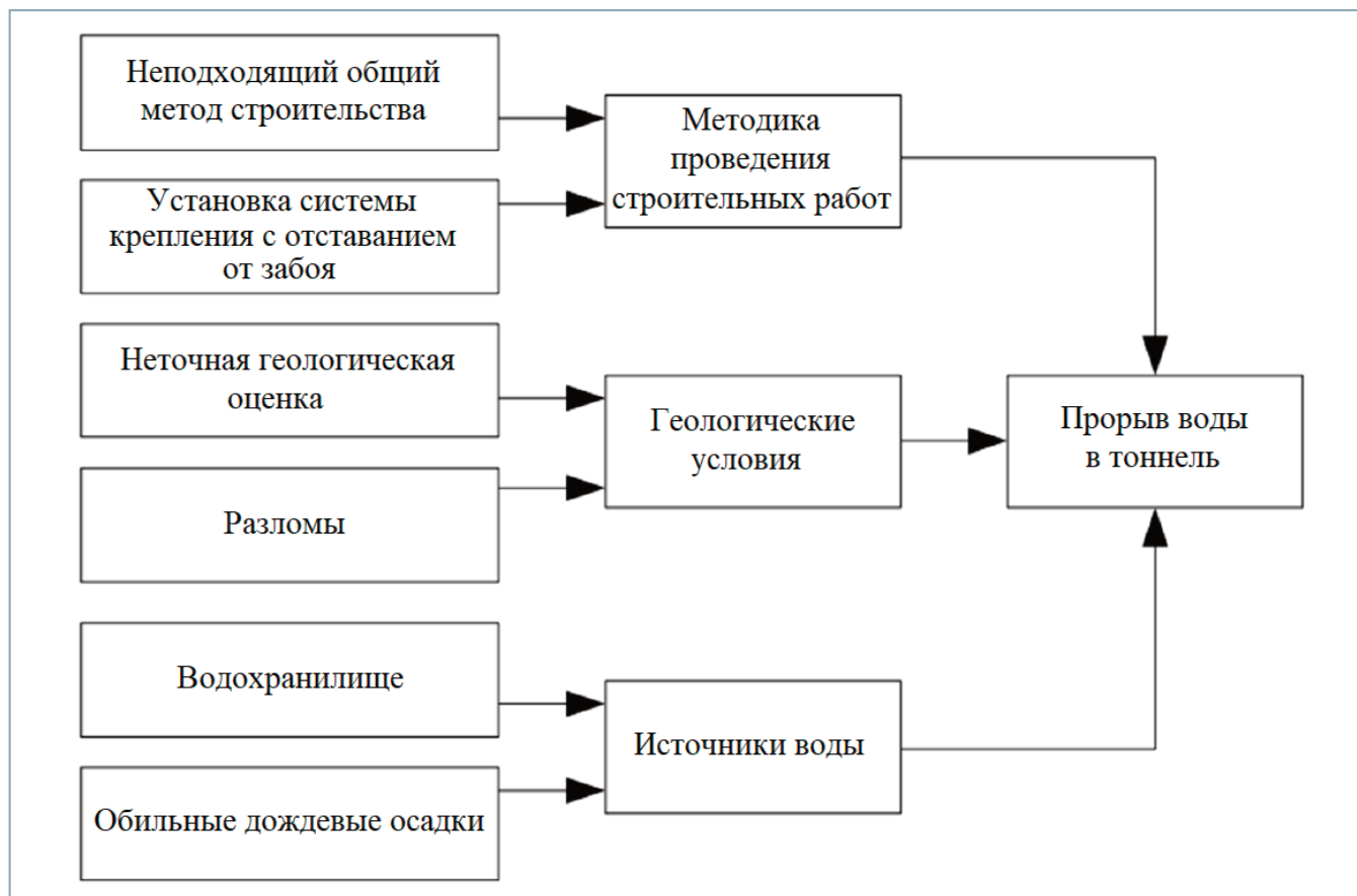
Рис. 9. Факторы, спровоцировавшие прорыв воды в тоннель
