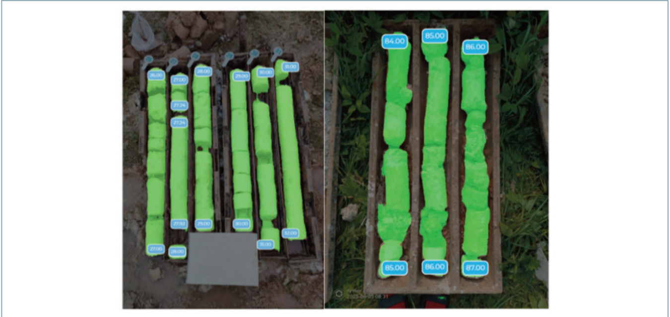
Рис. 5. Результат работы алгоритма сегментации и увязки керн по глубине. Зелёная область обозначает пиксели, где вероятнее всего лежит керн. На основе анализа производится автоматическая увязка согласно заданным параметрам без участия человека
