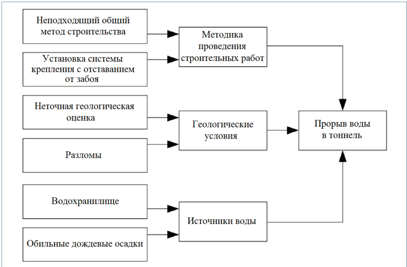
Рис. 9. Факторы, спровоцировавшие прорыв воды в тоннель
